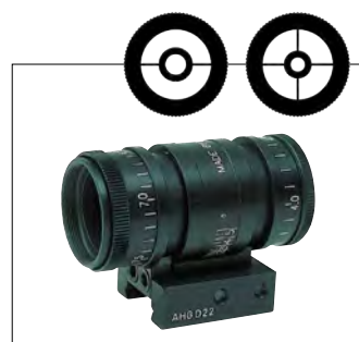
Duo-Ringkorn 9750 , mit Fadenkreuz/Querbalken 2,8 - 4,8 mm innen-Ø, verstellbar, 6,4 - 9,0 mm aussen-Ø, verstellbar. Duo iris aperture 9750, with cross/lateral hair 0.11 - 0.19 inch inner Ø, adjustable, 0.25 - 0.35 inch outer Ø, adjustable. Best.-Nr.: 001391
