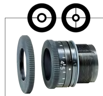
Super-Irisringkorn 9740 Ø 2,8 - 4,8 mm, verstellbar. Das Durchsichtsbild kann mit einem mitgelieferten Werkzeug von Fadenkreuz auf Querbalken stellt und somit den Wünschen des Schützen individuell angepasst werden. Dieses Ringkorn wird zusätzlich mit einem grösseren Rändelring geliefert, um das Zielbild besser abdecken zu können. Das ANSCHÜTZ Super-Iris-Ringkorn wird mit Einschraubgewinde M18 x 0,5 mm geliefert.
