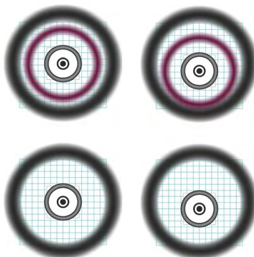
Kleinste Verlagerungen werden dann unmittelbar sichtbar, die Zielpräzision wird signifikant verbessert. Wird zur Lichtregulation die Iris-Diopteröffnung bei sich verändernden Lichtverhältnissen nachreguliert oder wird ein Filter eingeschwenkt, so kann der verstellbare Zentrier-Ring des Duplex-Vario entsprechend angepasst werden, wie bei einem verstellbaren Ringkorn. Eine Lösung, die nicht nur sehr komfortabel ist, sondern eine Lösung, die keine Kompromisse erfordert.
