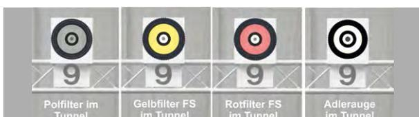
Diese genannten Filter dunkeln die Korntunneldurchsicht ab, dämpfen also die extreme Helligkeit der Scheibe. Der Raum zwischen Korntunnel und Irisöffnung bleibt hell, eine optimale Voraussetzung, um exakt zu zentrieren. Neben den Pol-Filtern, die Licht dämpfen, haben wir kontraststeigernde Filter für den Korntunnel entwickelt: die **Filter FS**, die zusätzlich über eine Mittelbohrung verfügen.
