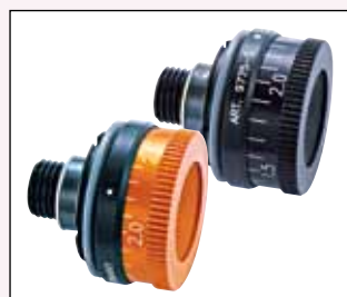
ahg IRISBLENDE • Augenmuschel mit abschraubbarem Blendingring SMALL. • Verstellbereich 0,5-3,0 mm. • 15 Lamellensegmente. • Extra kurze Baulänge. ahg IRIS DISC • Eyepiece with substitute color ring SMALL. • Adjusting range 0.5-3.0 mm. • 15 lamella segments. • Extra short. Orange/orange Art.-Nr.: 9775-O Schwarz/black Art.-Nr.: 9775-S
